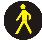
S 11b Doplnkový signál s prerušovaným žltým svetlom v tvare chodca
