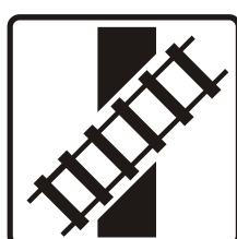
E 11 Tvar kríženia cesty so železničnou dráhou
