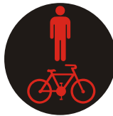
S 5c Kombinovaný signál pre chodcov a cyklistov s červeným svetlom so znamením "Stoj!"
